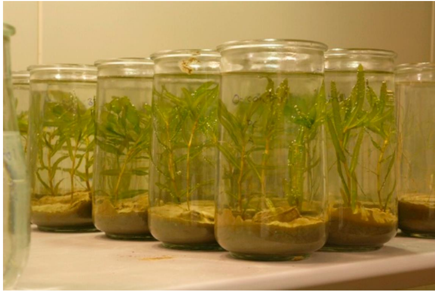
Figure 6: Tests de toxicité sur la végétation aquatique ou les invertébrés souvent réalisés à l'aide de petits bécards ; source : [9]
